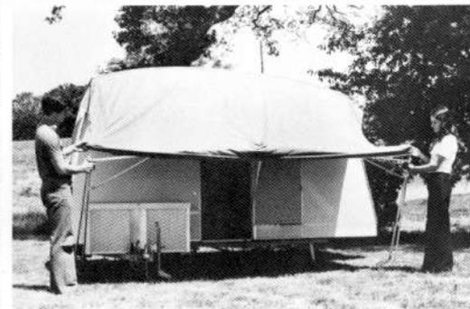
**34** La mise en place de l'auvent se fait en commençant par le toit, le jonc qui maintient l'auvent à la caravane est en deux parties de 1,50 m de long. Prenez le toit d'auvent par son milieu, introduisez-le jonc dans le rail d'abord côté droit de la caravane.
