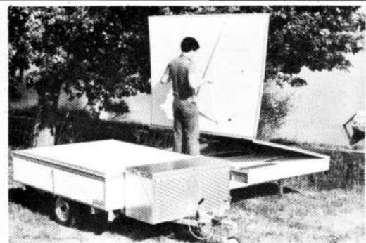
⑳ Emboîtez puis agrafez le second demi-toit. Le montage achevé, contrôlez la mise à niveau de la RAPIDO en montant ou baissant la roue jockey ainsi que les béquilles. Stabilisez la caravane en descendant les 4 vérins sous chassis.
