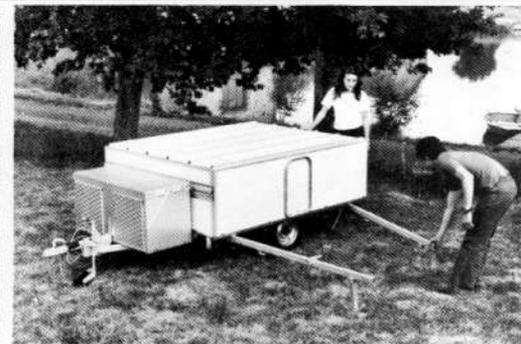
① Avant de détacher votre RAPIDO de la voiture, baissez la roue jockey et fixez-la à hauteur voulue. Roulez la remorque à l'emplacement souhaité, en vous rappelant que la baie ouvrante est située à l'opposée de la pédale d'ouverture. Sur un terrain en pente, orientez, si possible la flèche dans le sens de la montée ou de la descente du terrain ; réglez approximativement le niveau de la caravane à l'aide de la roue jockey
