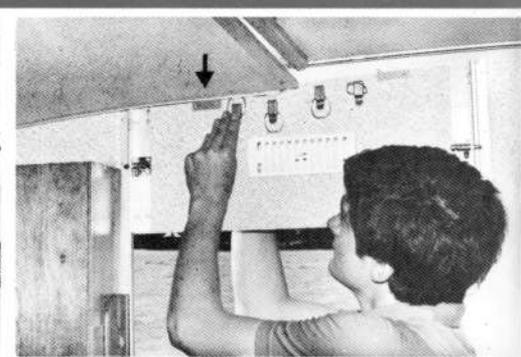
⑲ Maintenez l'écartement des montants de porte en vous adossant sur le montant côté table et en poussant l'autre montant, emboîtez et verrouillez l'autre extrémité des volets. Il vous faudra éventuellement agir sur le vérin arrière afin d'aligner les entailles de volets (photo 2).
